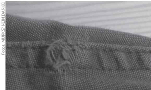
Die Qualität eines Textilstoffs hängt stark vom gewobenen Faden ab, die Qualität des Fadens wiederum von der Länge der versponnenen Fasern. Sind diese zu kurzfasernig, scheuert sich das Material zu schnell auf. Es kommt zum Aufflusen der Oberfläche.
