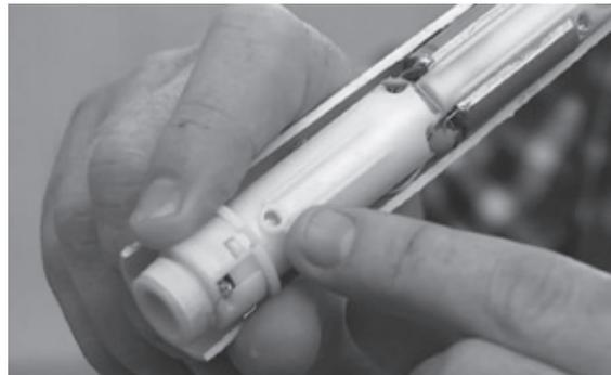
Bei elektrischen Zahnbürsten ist der Akku oft fest eingebaut. Seine Ladekapazität nimmt aufgrund der stets kurzen Ladezyklen ab. Zunächst ist nur noch kurzes Zähneputzen möglich. Ist der Akku dann erschöpft, muss das komplette Gerät entsorgt werden.
